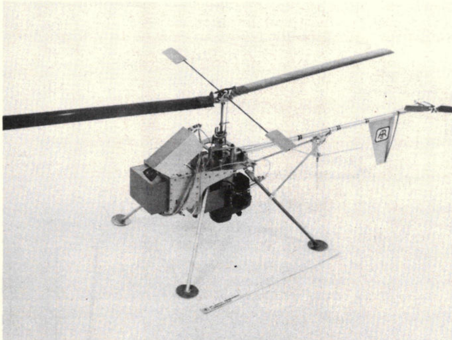
Miniatuur helikopter met televisiecamera. Duidelijk is op de kop van de „telekopter” de camera te zien en in het midden van de staart de tripoolantenne
