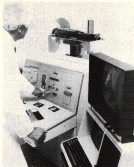
Beeld van een „Somatom”-installatie voor computer-tomografie. Op de achtergrond de patiënt, wiens hoofd wordt „getomografeerd”. Links op de voorgrond de bedieningslessenaar en rechts de monitor met daaronder het computer-station.
